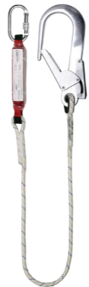
ABM + LB 101 amortyzator bezpieczeństwa ABM z linką LB 101 o dł. 2 m + AZ 011 + AZ 023 (otwarcie 56 mm)
